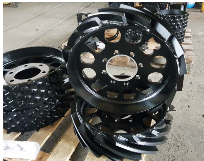
Ülemisel pildil: Alusevahetajaga CNC-freesimiskeskuse üldvaade. Alumisel pildil: Eukalüpti koorimiseks mõeldud harvesteri veorullid enne pakkimist ja Uruguaysse saatmist. Piltide autor: Siim Soomägi
