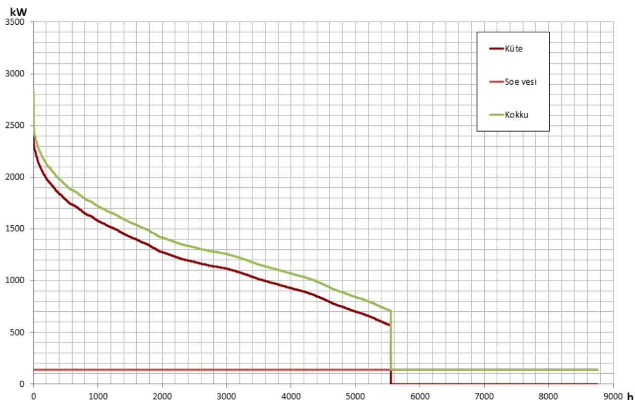
Joonis 2.2 Tootsi katlamaja soojuskoormuse kestusgraafik tegelike tarbimiste alusel
